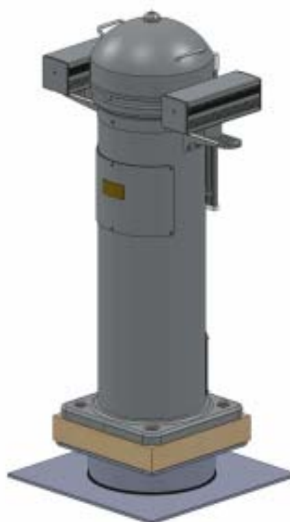
Монтаж и фиксация нактоуза
